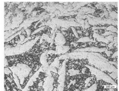
Bild 5: links: Schliff mit bänderförmiger Anreicherungszone 5 % AlMg4,5Mn-Pulver + 5 % Al 2 O 3 , rechts: Schliff durch eine Anhäufungszone von Spänen und Partikeln in einem Gussteil (5 % AlMg4,5Mn + 3 % SiC + 1 % TiH 2 )
