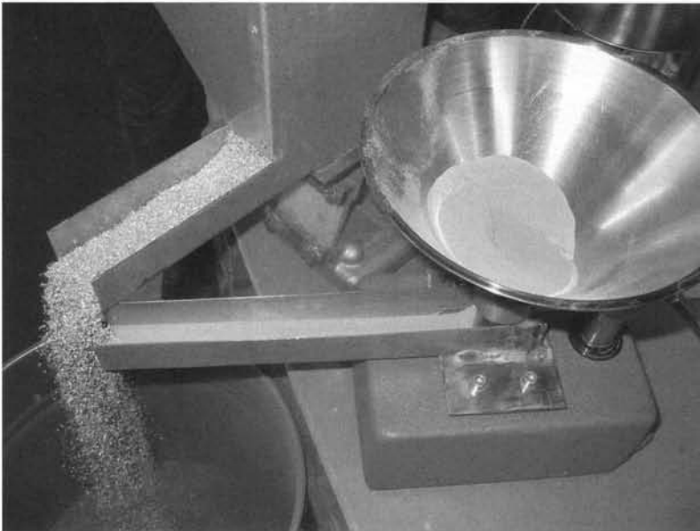
Bild 1: Versuchsanordnung zur Herstellung einer homogenen Span-Pulvermischung
