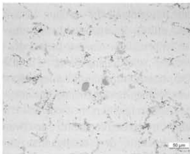
Bild 3: Gefüge der Probe 5% AlMg4,5Mn-Pulver + 1% TiH 2 , in Bildmitte TiH 2 -Teilchen
